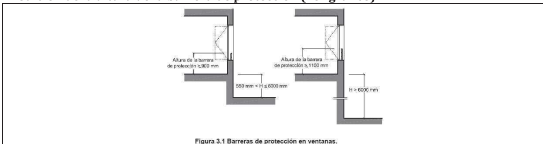
Figura 3.1 Barreras de protección en ventanas.
