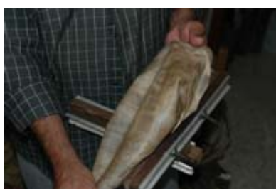
Proceso de estirado y secado de la piel con herramienta de fabricación propia.
